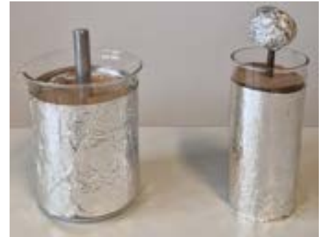
Abbildung 67: Selbstgebaute Leidener Flaschen als Ladungsspeicher
