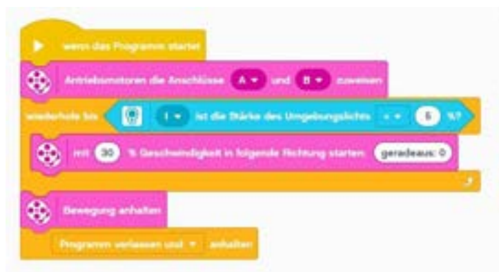
Abbildung 77: Programmierung der Aufgabe: Fahre bis zu einer schwarzen Linie
