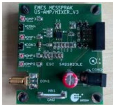
Abbildung 73: Ansteuerungs- und Messplatine für die Ultraschallgeber
