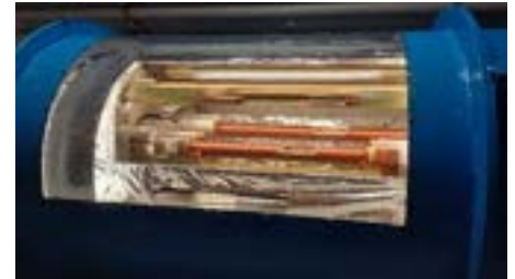
Abbildung 129: Strahlrohre im Dipol-Magnet
