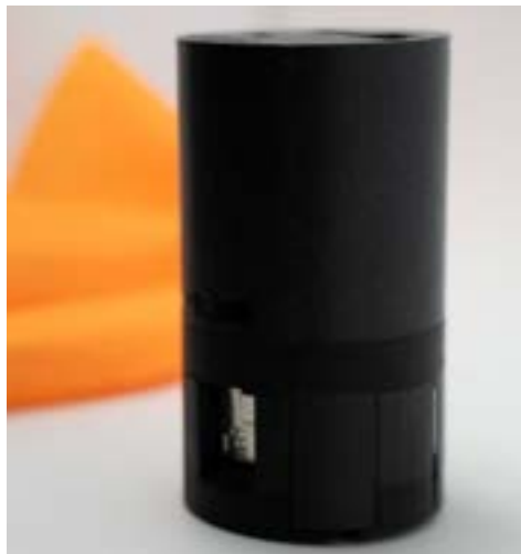
Abbildung 83: montierter Satellit in der Größe einer Getränkedose
