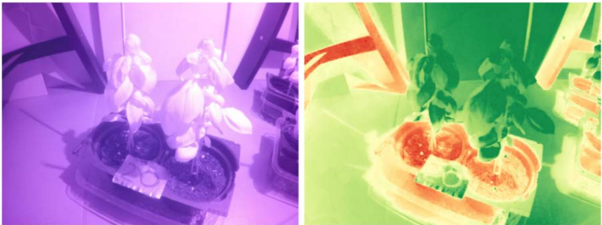
Abbildung 4: Linkes Bild Rohdaten. Rechtes Bild erste berechnete NDVI-Darstellung mit Color-Map
