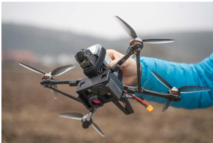
Abbildung 10: Drohne mit Kameramodul
